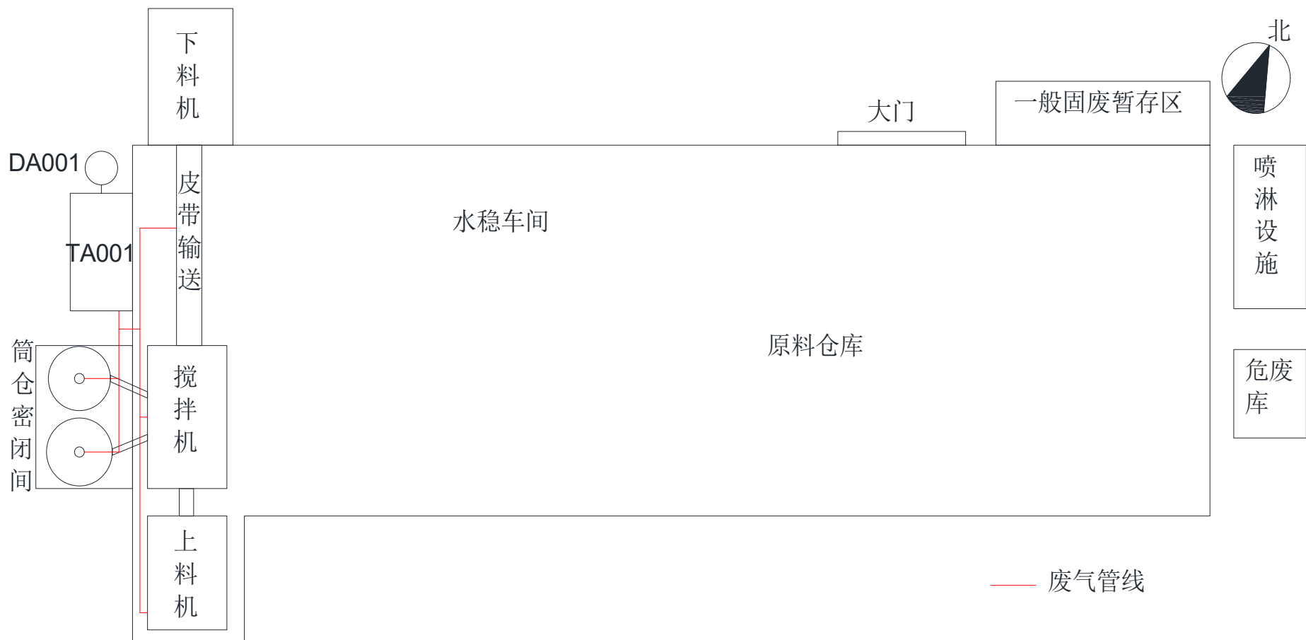
附图 4 车间平面布置及废气管道走向示意图
