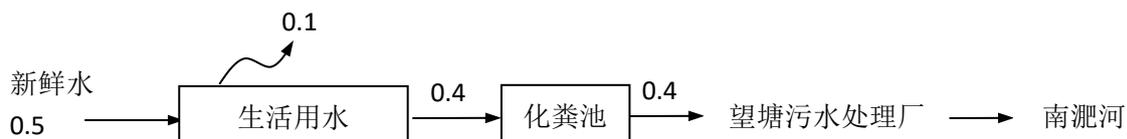
图 2-1 本项目水量平衡图 (t/d)
